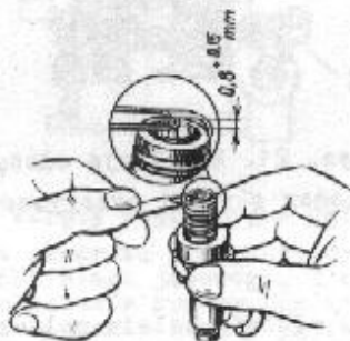
Rys. 23. Sprawdzenie odstępu między elektrodami świecy zapłonowej
